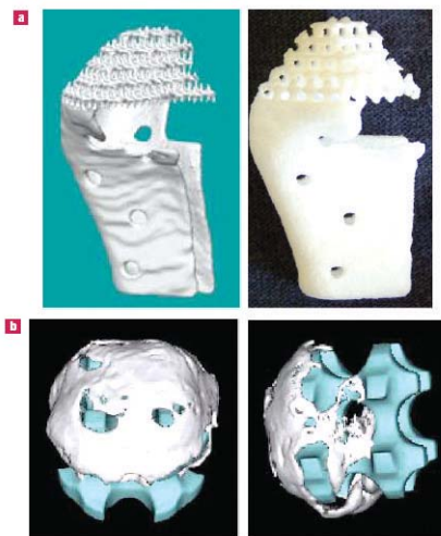
그림 4. SLS에 의해 제작되었던 PCL 스캐폴드. a: SLS에 의해 제작된 Mandibular condyle 디자인과 PCL 스캐폴드. b: PCL 스캐폴드에서 뼈의 성장을 보여준다 (흰색은 뼈의 이미지이고, 푸른색은 스캐폴드의 이미지이다.).
