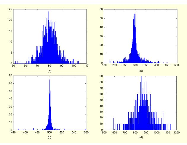
Fig. 6. Histogram of GOP-rate distribution: (a) 80 kbps, (b) 300 kbps, (c) 500 kbps, and (d) 900 kbps.
