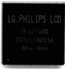
팹리스 반도체기업 티엘아이의 'TV용 LCD 모듈의 화질향상형 메인 제어칩'은 LCD 특유의 느린 응답속도를 해결하기 위한 ODC(Over Driving Control)기법을 최초로 구현하여 적용한 제품군이다.
