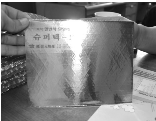
▲슈퍼텍-F, 얇고 가벼워 시공이 쉽다
