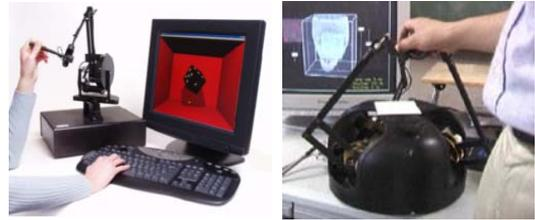
(그림 5) PHANTOM과 Iwata의 Haptic Master
