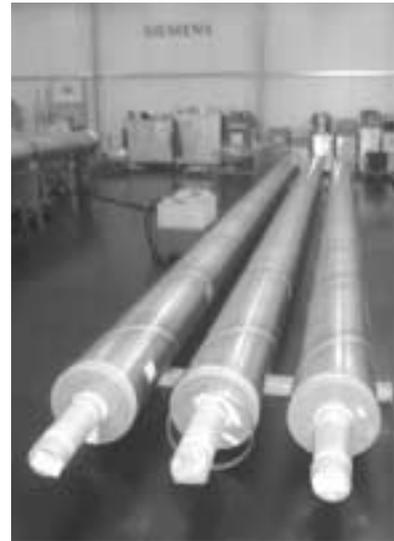
필요하지만 각 부품을 취부하여 제작하여 현장에 운반한다. 그러나 기차나 차량이 터널 안까지 진입이 용이한 곳은 20m~30m GIL Unit을 조립하여 운송하거나 cargo lifter 운송으로는 길이 100m까지 운송이 가능하다. 이러한 길이의 증가는 조립작업의 양과 시간을 줄이기 때문에 시공비를 절감할수 있다.
