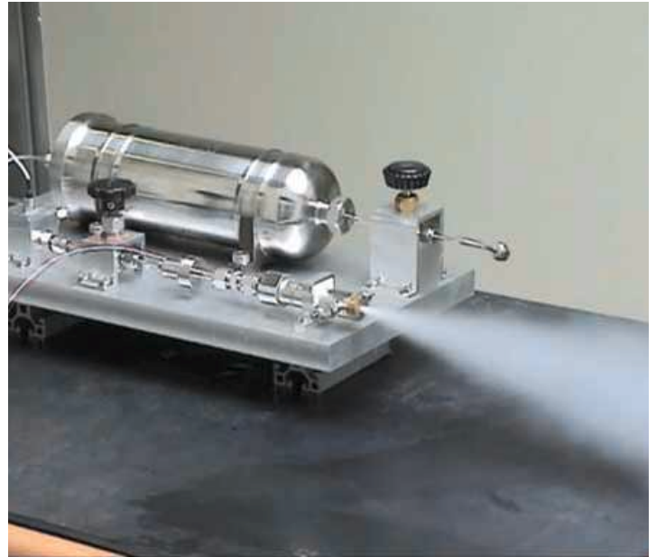
〈그림 6〉 추진기 모듈 시험 광경
