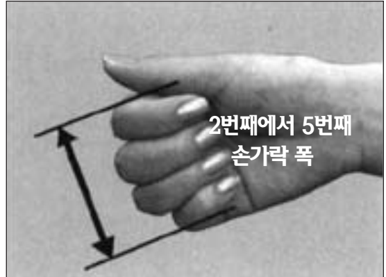
[그림2] 잡기 쉬운 손잡이의 크기([그림 1] 내①)
