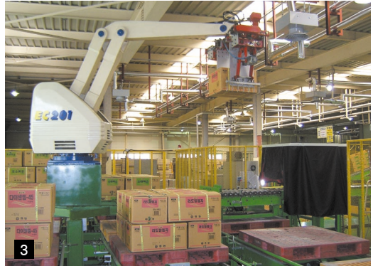
1. 유액제라인의 로타리 필러(filler) 2. 수화제 라인의 실링(sealing) 장면 3. 바코드를 인식, 제품별 자동 적재가 가능한 로봇 파레타이저(Palletizer)
