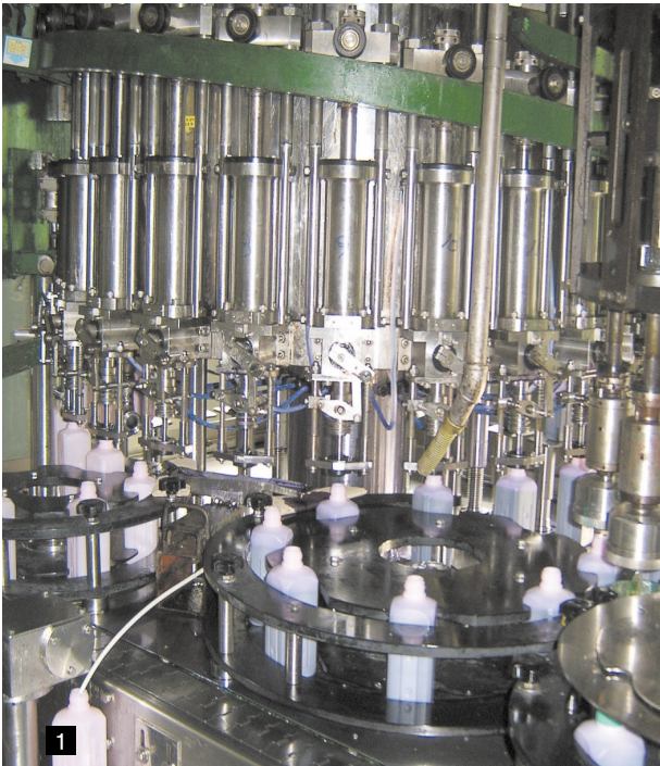
1. 유액제라인의 로타리 필러(filler) 2. 수화제 라인의 실링(sealing) 장면 3. 바코드를 인식, 제품별 자동 적재가 가능한 로봇 파레타이저(Palletizer)
