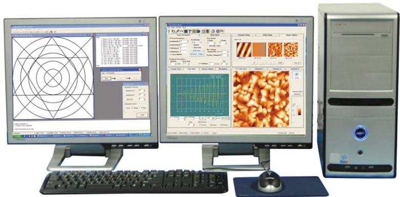
을 분석할 수 있는 장비로 기존의 주사전자현미경(SEM)과 투과전자현미경(TEM) 분석 장비는 진공 상태에서만 측정 가능하지만, AFM은 진공 상태나 대기 중뿐 아니라 액체내에서도 측정이 가능해 폭넓은 응용분야를 가진다.
