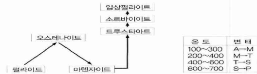
[그림 2] 뜨임에 따른 조직 변화 [그림3] 뜨임조직의 변태
