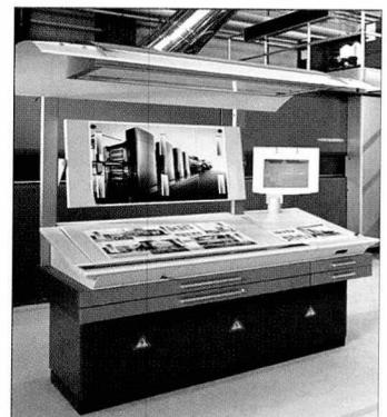
표준과 호환된다. 또한 윈도우 NT 오퍼레이팅 시스템에 설치돼 고객화 콘트롤을 위한 소프트웨어와 하드웨어간의 연결까지 제공한다. 이 시스템은 옴니컬러 콘솔에 포함된 옴니콘 프레스 콘트롤로 원거리 모니터링이 가능하다. 대형 터치스크린을 통해 기장이 디지털 데이터를 불러오면 사전 설정된 생산 데이터를 검사해 자동화된 공정을 시작할 수 있다.
