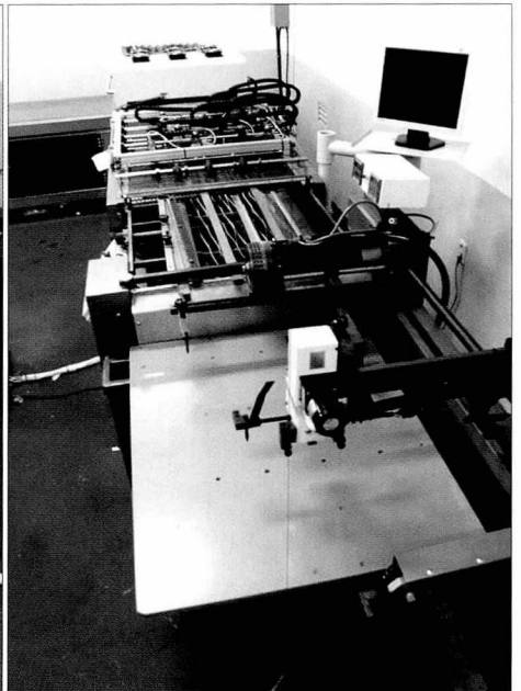
에스피라인은 넘버링 인쇄를 잉크젯으로 할 수 있는 장치를 주문 제작, 2005년 8월에 설치했다. 또한 반자동으로 이뤄지는 스크래치 인쇄작업을 자동으로 교체하는 작업을 올해 연말까지 마무리할 계획이다.
