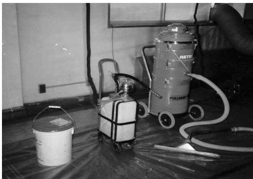
〈그림 3〉 HEPA Filter가 내장된 진공청소기
