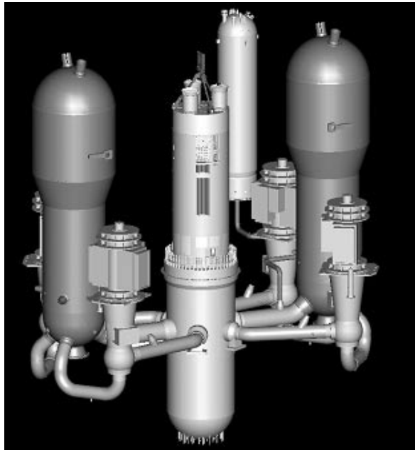
〈그림 1〉 APR1400 핵증기 공급 계통의 주요 기기
