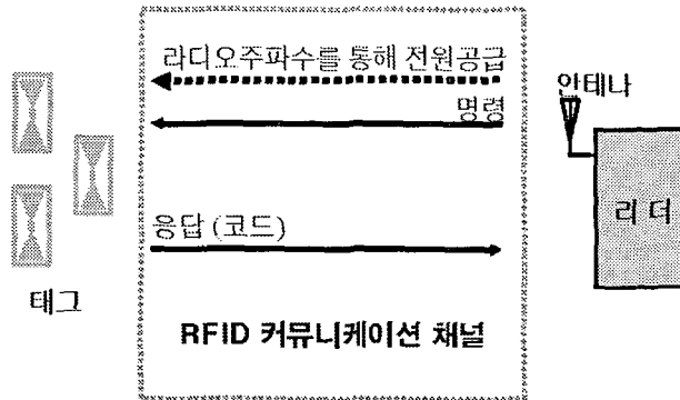
<그림 2> RFID 작동원리(MIT Auto-ID센터, 2004)
