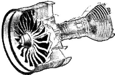
GENx 엔진은 엔진 팬 케이스와 팬 블레이드가 모두 복합재로 만들어진 세계 유일의 제트 엔진이다. 새로운 엔진은 항공기 전체의 무게를 줄이고, 짐 적재량을 늘리며 운항거리를 늘릴 것으로 보인다. ATK사에 의해서 처음으로 개발되어지는 GENx 엔진의 팬 케이스는 2007년 봄에 인도되어지도록 계획되어져 있다.
