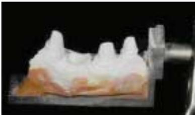
[그림 1] model를 laser scan 하기 위해 holder에 고정한다.
