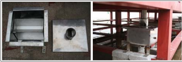
그림 16. Tipping Buckets 실험구 설치모습
