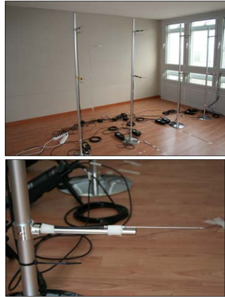
그림 5. 실험실내 장비설치 전경(상), 설치된 Testo Velocity Probe 근접촬영(하)
