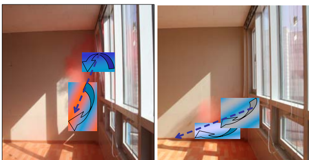
그림 8. 난방기 중 싱글외피 상단창 tilt 개방시(좌) 및 하단창 Pull-down 개방시(우) 연막실험 결과
