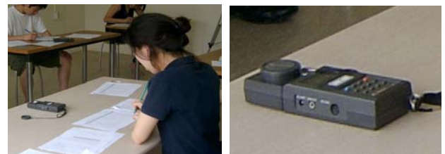
그림 6. 작업면 조도의 측정모습 및 기기(IM-5)
