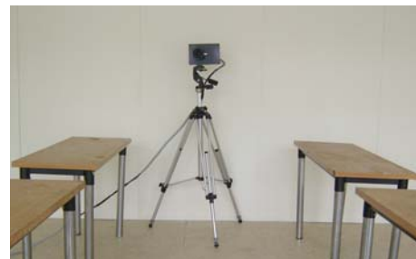
그림 7. 휘도의 측정모습 및 기기(Prometric 1400)
