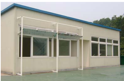
그림 3. 연구대상 mock-up 및 광선반 채광시스템의 사진
