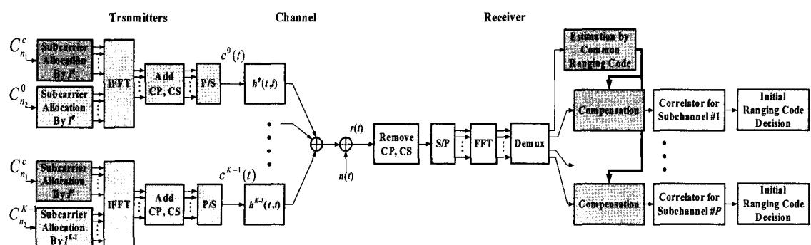
그림 4. 공통 레인징 부호를 사용하는 OFDMA 상향링크의 기저대역 등가모델
