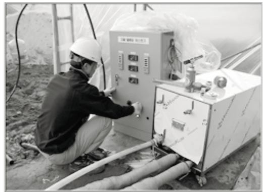
<그림 3> 지열 열전도도 개념도 및 테스트
