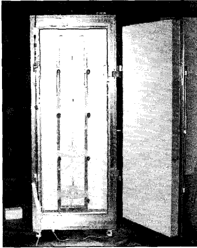
그림 4. 챔버 내부의 환기 장치 및 조명 Fig. 4. Picture showing illumination and ventilation facilities inside of the chamber.
