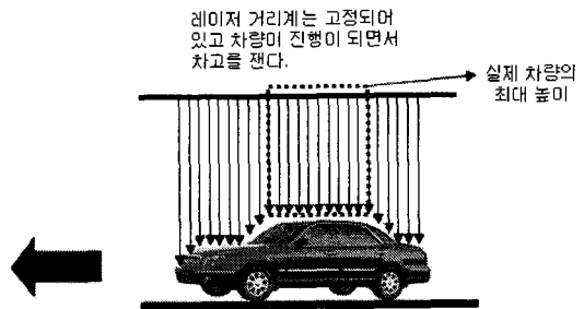
그림 9. 차량이 진행할 때 높이 측정 방법 Fig. 9. Detection method of vehicle's height as moving ahead
