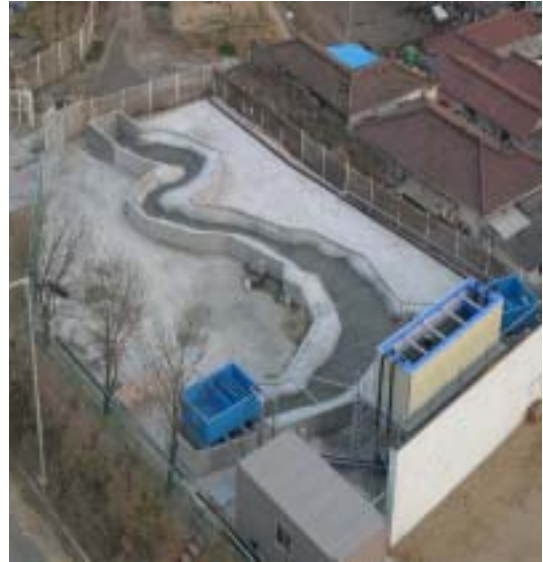
그림 2. 원형하천의 평면도 및 제작된 모형수로
