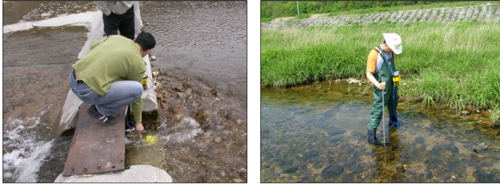
그림 6. 유속계를 이용한 유속 측정
