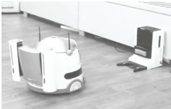
그림 17. 자기 위치 센서에 의하여 Parking Zone 도착 모습
