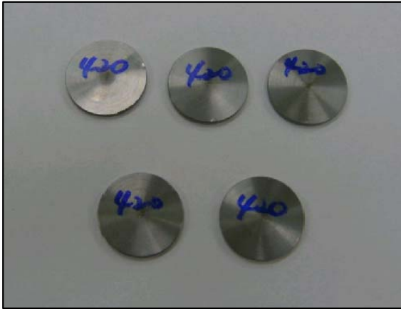
Fig. 3 성분분석 시험편 제작 (Size : \varnothing 35 , 두께(t) \geq 1 mm)
