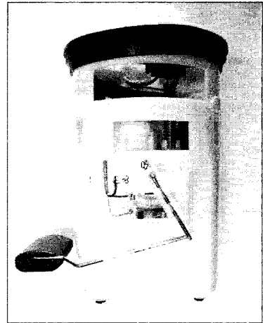
그림 1. 기존의 floating 방식의 연료 센더 모듈 Fig. 1. Conventional floating type fuel sender module.
