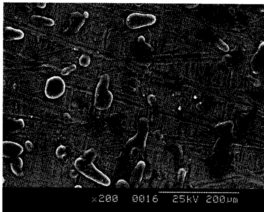
그림 7. 가스용사법에 의해 형성된 동판의 초기 미세 표면 모습
