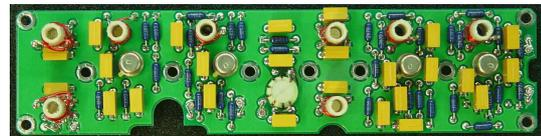
그림 12. 제작된 X9 주파수 체배기 사진
