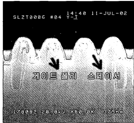
그림 3.3. 측벽 스페이서 형성 후 SEM 분석사진. Fig. 3.3. The SEM photograph of side wall spacer.
