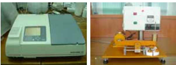
그림 1. 투과율 측정기(좌)와 내마모성 측정기(우)
