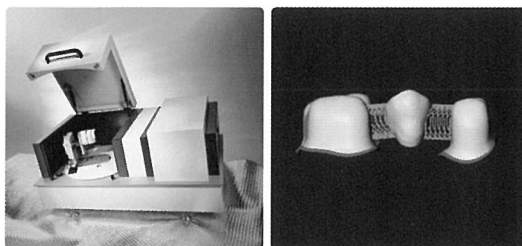
|| 그림 10. LAVA™를 이용한 coping의 제작과정. Scanning & designing
