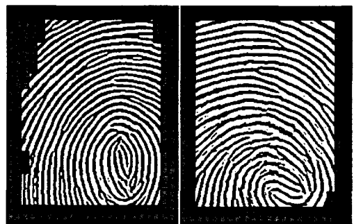
그림 4. 방향성 라플라시안 필터를 적용한 결과 Fig 4. Result that apply directional Laplacian filter
