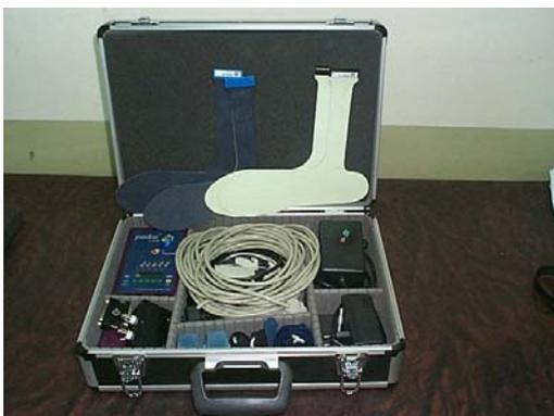
그림 2. Pedar Insole 압력분포 측정시스템
