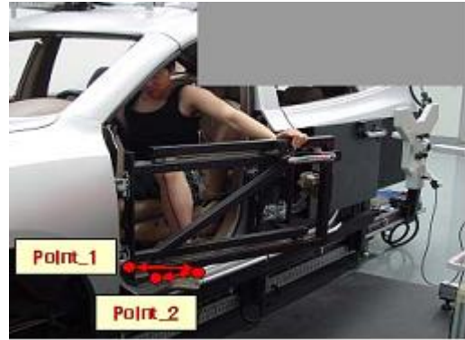
그림 14. Ankle sensor와 A-Pillar 하단의 위치
