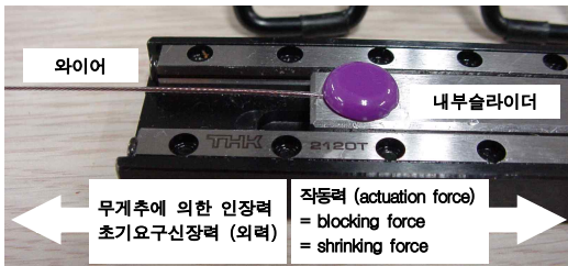
그림 6. 작동력 측정 장비와 작용력의 방향
