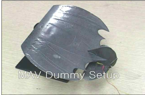
그림 14. 조종면 작동 실험용 MAV (BATWING)
