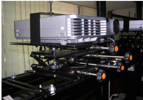
Fig. 9. 위치조절장치에 고정된 빔프로젝터
