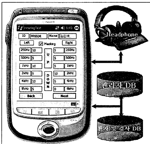
그림 2. PDA 청력 검사 시스템의 기본 구성도 Fig. 2. PDA Based audiometric system structure.
