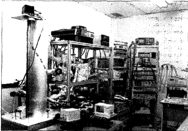
Fig. 4. 저진공 국가표준기인 초음파간섭 수은주압력계 (UIM) 사진.
