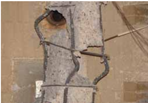
Photo 6 내화시험 후 기둥주근의 좌굴 모습
