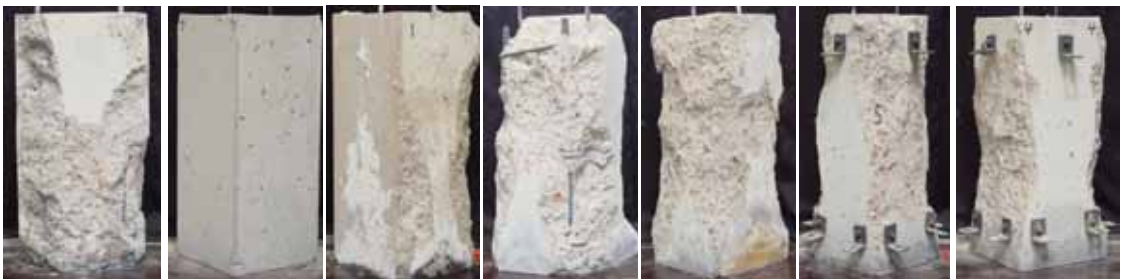
플레인 PP섬유 0.1% 내화도료 내화뿔칠 석고보드 대리석 내화 PC판 Photo 4 마감재 변화 및 PP섬유 혼입 고성능 RC 기둥의 내화시험 후 폭열 모습
