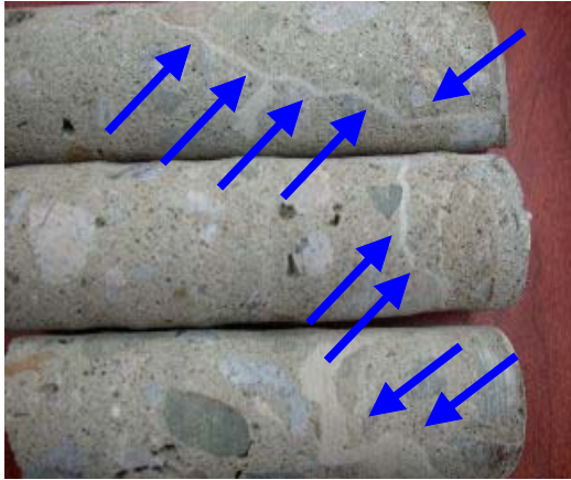
(c) 균열 폭과 깊이에 의한 주입 확인
