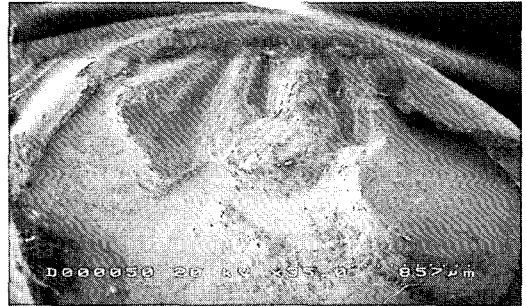
(a) 응력 집중부의 피로파면 (30 mm, 40.0 kgf/mm 2 )
