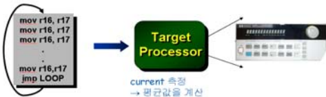
그림 7. mov 명령어의 소모 전류 측정 과정 Fig. 7. Process of measuring power consumption of mov instruction
