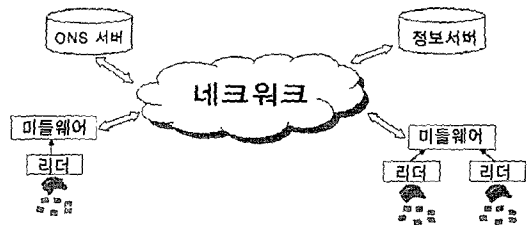
(그림 1) RFID 시스템 구성 요소 및 동작 흐름
