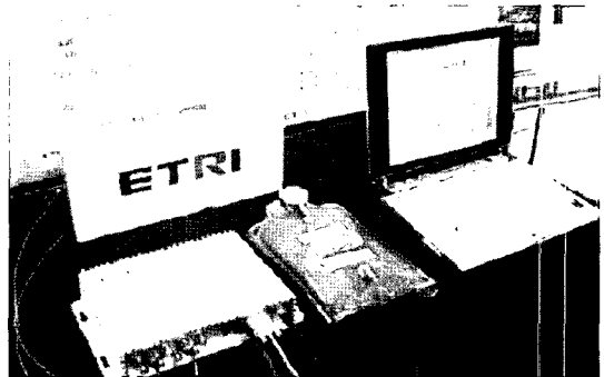
(그림 2) ETRI가 개발에 성공한 신개념 RFID 혈액관리용 센서 Tag 시스템
