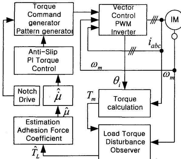
그림 4 부하 토크 외란 관측기를 이용한 Anti-slip PI 토크 제어 시스템
