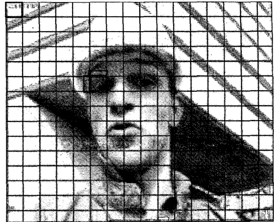
그림 2. 영상 한 프레임을 매크로블록 단위로 나눔 Fig. 2. Division of one image frame into macroblocks.
